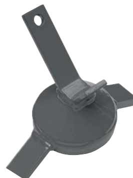
Obrázek 11.1: Míchačka pro granulované hnojivo
